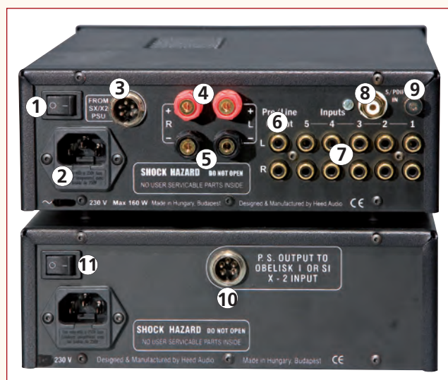
Vue de l'arrière de l'Obelisk Si 1 – Interrupteur marche/arrêt. 2 – Prise secteur avec en dessous, logement du fusible de protection. 3 – Prise multibroches pour alimentation supplémentaire extérieure X2. 4/5 – Bornes de sorties haut-parleurs. 6 – Fiches Cinch de sortie asymétrique section préampli. 7 – Les cinq entrées asymétriques Cinch haut niveau. 8 – Entrée numérique SPDIF coaxiale. 9 – Borne vissante de mise à la masse pour table de lecture. 10 - Prise de sortie alimentation supplémentaire X2. 11 - Interrupteur marche/arrêt.
