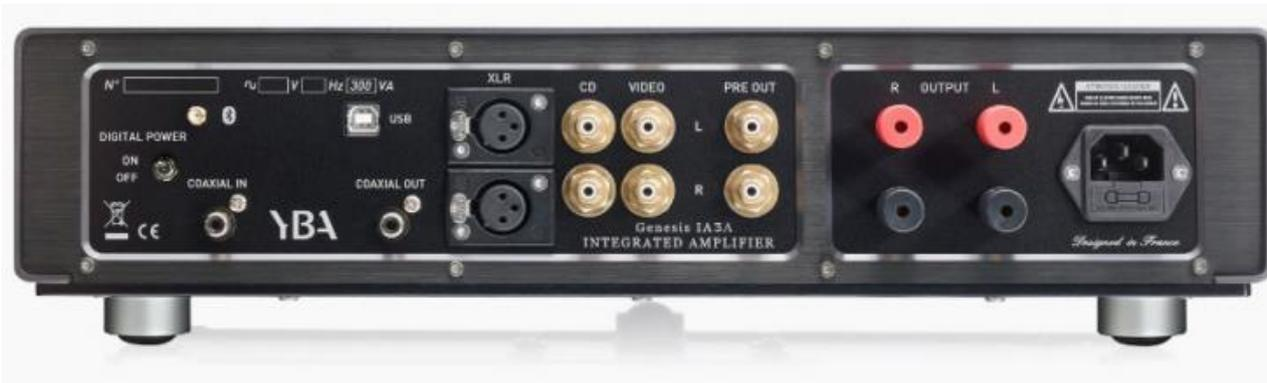
Le panneau arrière a, lui aussi changé d'apparence. Les 5 entrées haut niveau, et la boucle entrée / sortie enregistreur analogique de l'Intégré Classic laissent la place à 3 entrées Ligne dont 1 au format XLR et 1 sortie Ligne variable. Le concepteur précise que l'on peut câbler la source uniquement en asymétrique si on le désire, afin d'être plus prêt du fonctionnement d'une entrée RCA et d'éviter de solliciter un étage supplémentaire.
